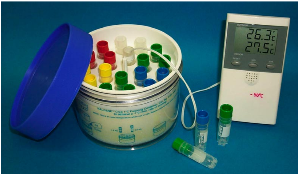
Figure 16. Congélation lente par Nalgene™ cryo 1°C Freezing Container avec sonde de température.
