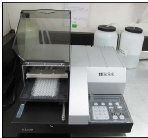
Figura 42. Máquina lavadora de placas de ELISA (cada ciclo de lavado en esta máquina dura aproximadamente 6 minutos).
